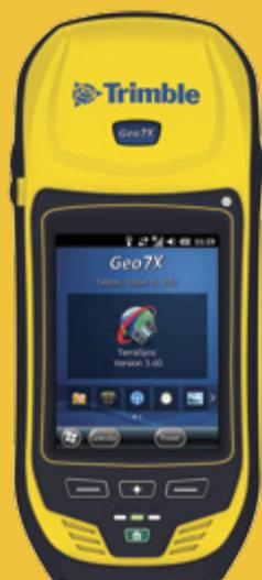
Il robusto palmare Trimble® Geo 7X con il software Trimble Access™ è una soluzione completa studiata per facilitare e rendere più flessibile ed efficiente sia il rilievo ad alta precisione che la misurazione dei punti con il palmare.
