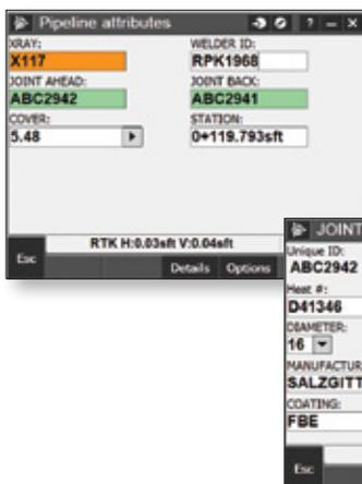
Inserimento della saldatura, del giunto precedente e successivo. I dettagli possono essere raggiunti cliccandoci sopra.
